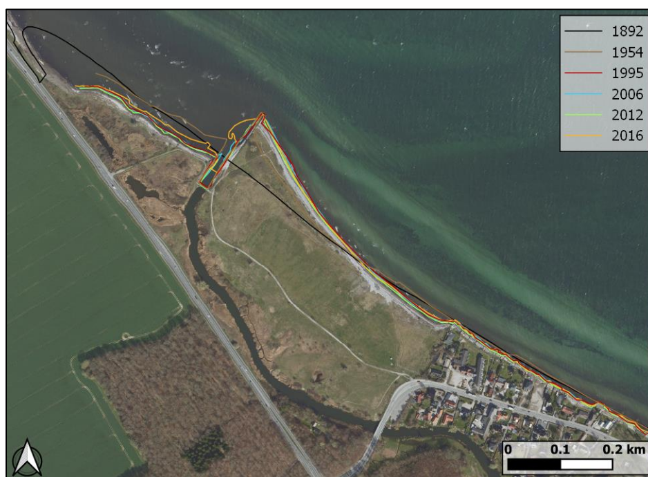
Figur 5.3: Historisk udvikling af vandlinjen mellem 1892 og 2016 for hele kyststrækningen: Billede 1: St 0-1400 Billede 2: St 1400-2650 Billede 3: St 2570-3930 Billede 4: St 3840-5200 Billede 5: St 5170-6530 Billede 6: St 6450-7750
